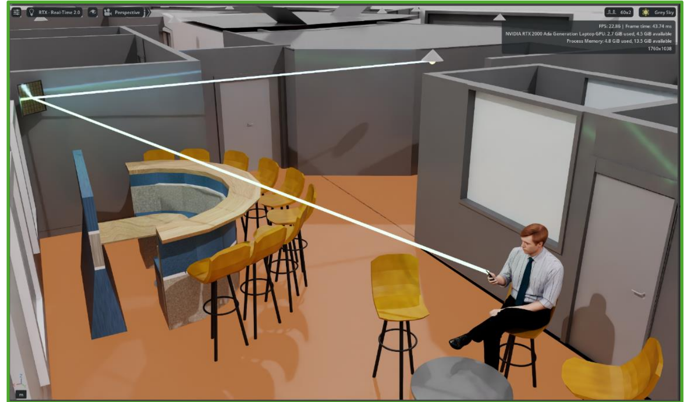
Illustration montrant l'utilisation d'une RIS afin de rediriger le signal dans une zone d'ombre
